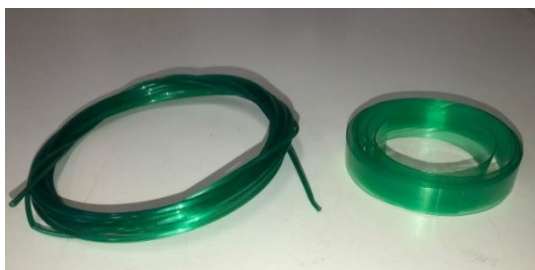
Figura 8: Material filetado e extrusado de espessura de 1 cm (esquerda), material apenas filetado de espessura de 10 cm (direita).
