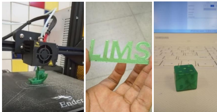
Figura 9: Objetos impressos com filamento de PET em Impressora 3D.
