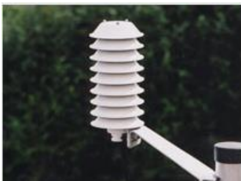
Figura 9: Abrigo dos sensores utilizado nas estações automáticas do INMET.
