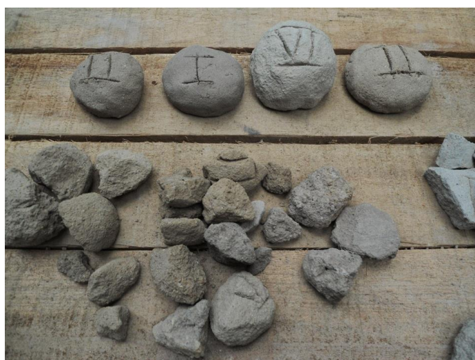
Figura 4. Teste da bolacha de barro
